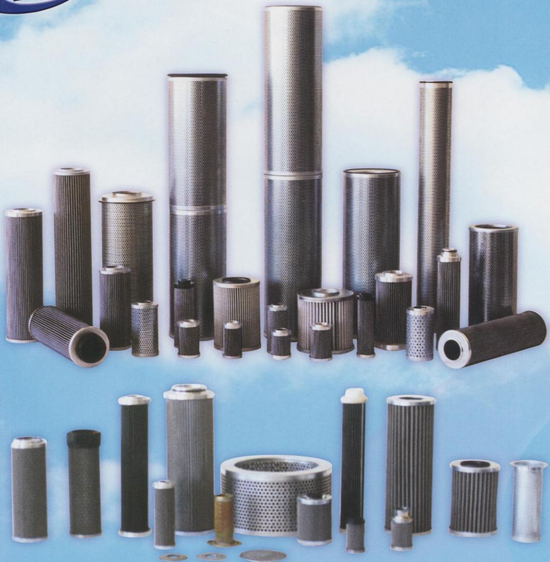
Hassas filtreleme alanında giderek yaygınlaşan mikroglas esaslı hidrolik filtreler imalat programımıza dahil ürünlerin gurubundandır. Bu guruptaki ürünler çift kat laminasyonlu cam lifi esaslı alt ve üst özel tel takviyeli olarak 1-3-5-10-15-25 mikron değerinde dönüş ve basınç hatlı hidrolik filter uygulamaları için imal edilmektedir. Ürün programımıza dahil olan dünya çapındaki üreticiler: PALL-HYDAC-ARGO-PARKER-ARCON-M.P-FLEETGUARD-DONALD-SON vs. sıralanabilir.
